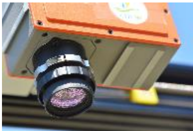
Caméra hyperspectrale Specim FX17 (900-1700 nm)
