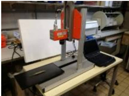
Caméra hyperspectrale Specim FX17 (900-1700 nm) Combinée à un plateau mobile
