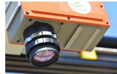
Caméra hyperspectrale Specim FX17 (900-1700 nm)
